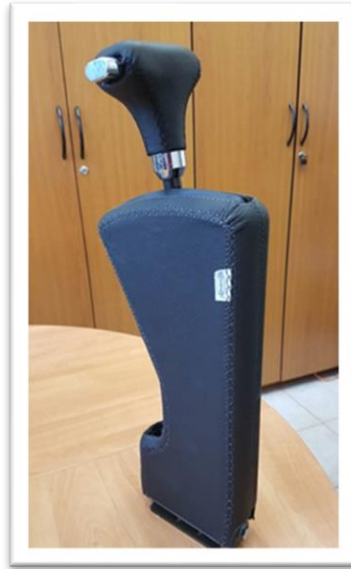
Rys. 6. Mechaniczny sterownik gazu (przyspieszenia) i hamulca Źródło: ITS
