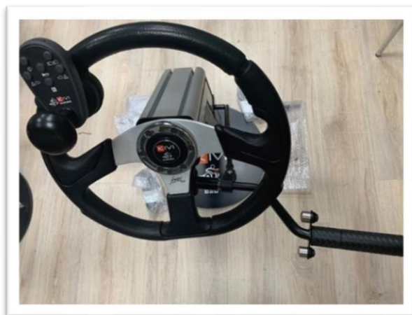
Rys. 10. Kivi, gaz i hamulec w drążku pod kierownicą, wielofunkcyjny pilot Źródło: ITS
