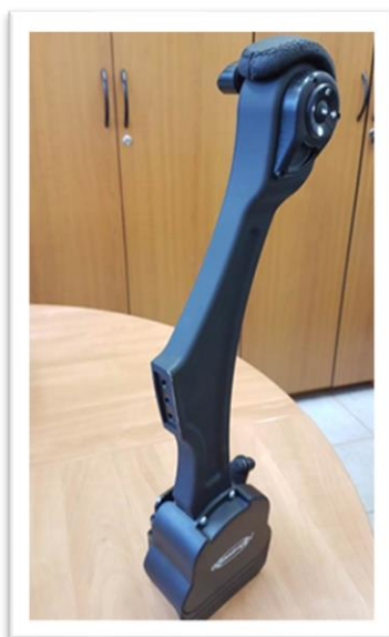
Rys. 7. Elektroniczny sterownik gazu (przyspieszenia) i mechaniczny hamulca Źródło: ITS
